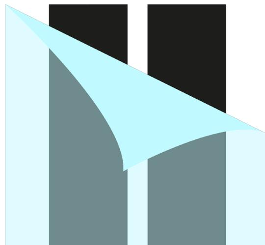
10. Retirer le film de transfert délicatement et nettoyer l'ensemble. S'il reste quelques bulles, chasser l'air avec la raclette ou percer avec une aiguille.
